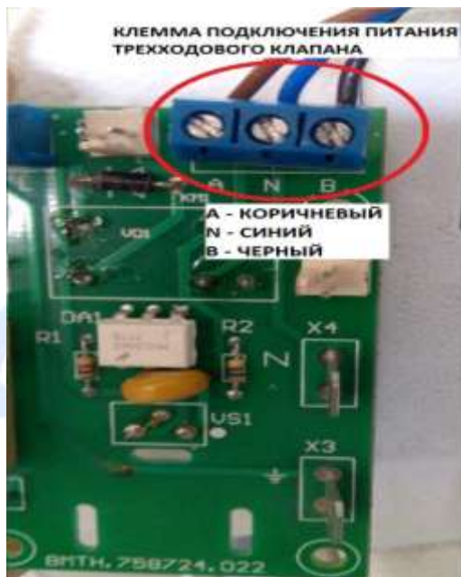
Рисунок 13. (плата управления насоса)
