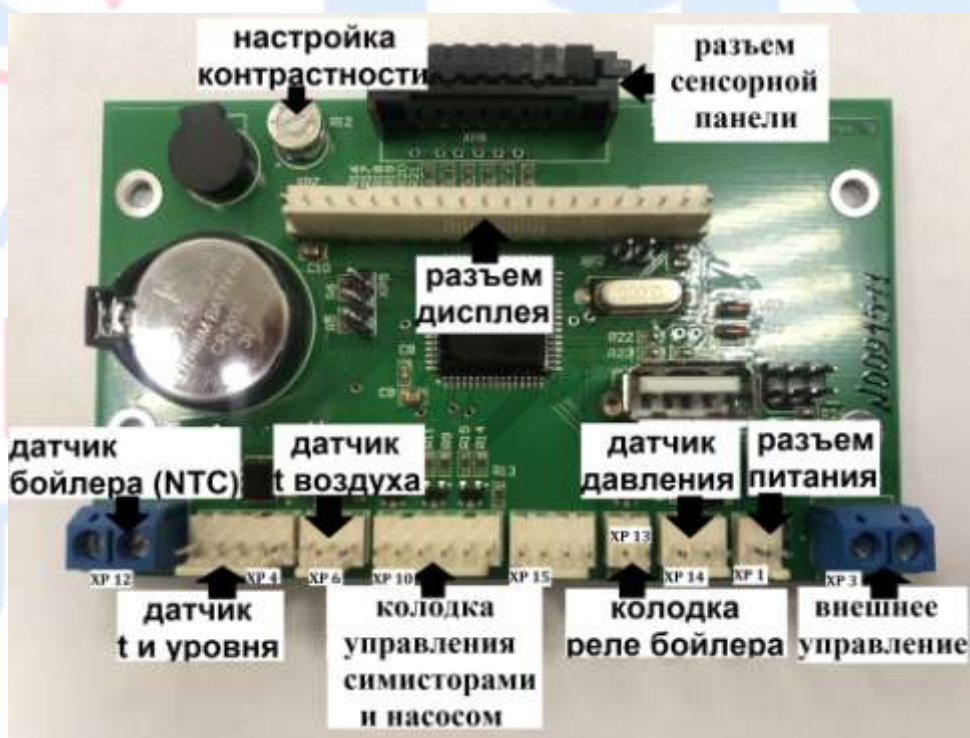
Общий вид платы управления (РЭКО серии П, ПМ)
