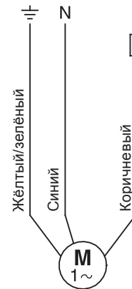
Рис. 21 Электродвигатели с двухпроводным кабелем
