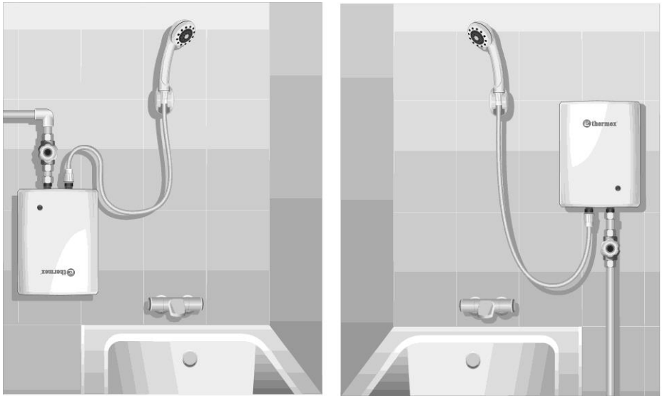
Рис 1. Варианты установки THERMEX Surf 3500, Surf 5000 и Surf 6000
